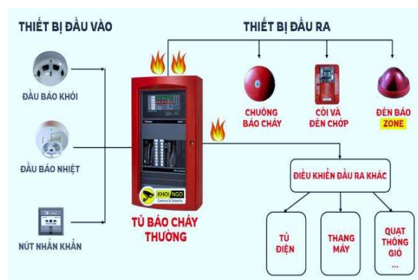
Hình 2. Hệ thống báo cháy thông thường
