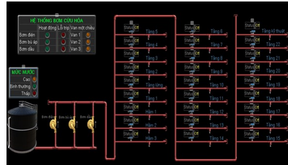
Hình 10. Màn hình giám sát hệ thống bơm nước chữa cháy ứng dụng BMS
