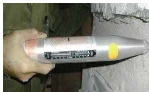
Hình 1. Hình ảnh kiểm tra bê tông bằng búa bật nảy
