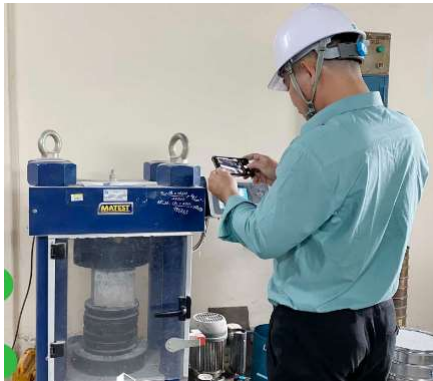
Hình 4. Nén mẫu bê tông bằng máy nén mẫu
