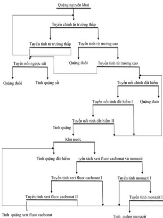
Hình 5. Sơ đồ công nghệ tuyển quặng đất hiếm mỏ Bao Đầu, Trung Quốc [20]
