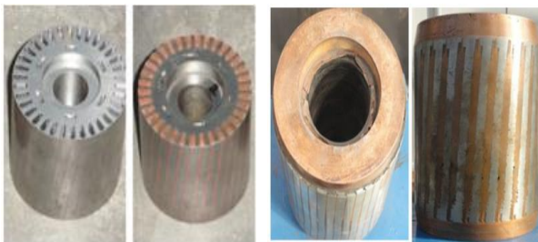
Hình 4. Thanh dẫn rôto lồng sóc động cơ điện đúc bằng đồng nguyên chất [5]
