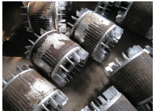
Hình 3. Thanh dẫn rôto lồng sóc động cơ điện đúc bằng nhôm nguyên chất
