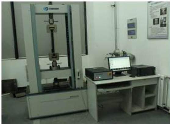
Hình 4. Hệ thống máy nén Servo universal testing machines of DNS-100
