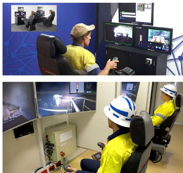
Hình 1. Các công nhân vận hành máy khai thác trong trung tâm điều khiển trên mặt đất [8]
