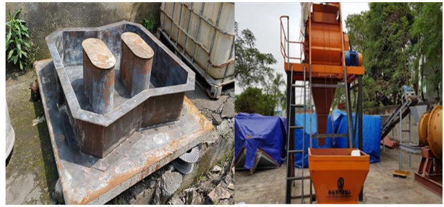
Khuôn đổ khối bê tông tự chèn
